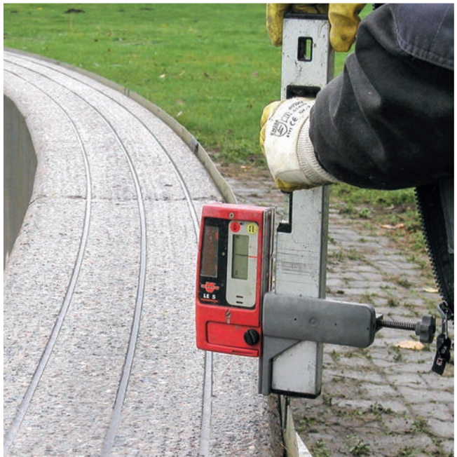
Höhengerechte Laufbahnen sorgen für minimalen Verschleiß der Räumertechnik
