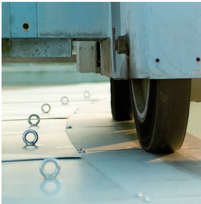
Vie di corsa perfettamente planari garantiscono una minima usura del carroponete
